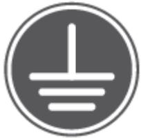
Класс I – заземление проводящих частей прибора через вилку (дополнительный заземляющий кабель – PE)
